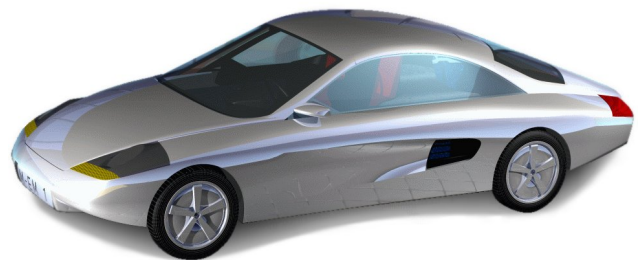
Bild 3: Digitalisierung des abgetasteten Clay-Designs aus dem Jahr 2000/2001
